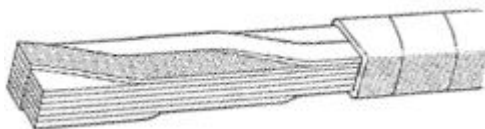
شکل (۳-۱۳): ترانسپوزه کردن هادی‌ها بمنظور کاهش اثر پوستی
