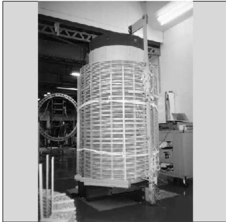
شکل (۳-۱۹): مدل با مقیاس واقعی سیم پیچ ترانسوزه شده با صفحات مجزا
