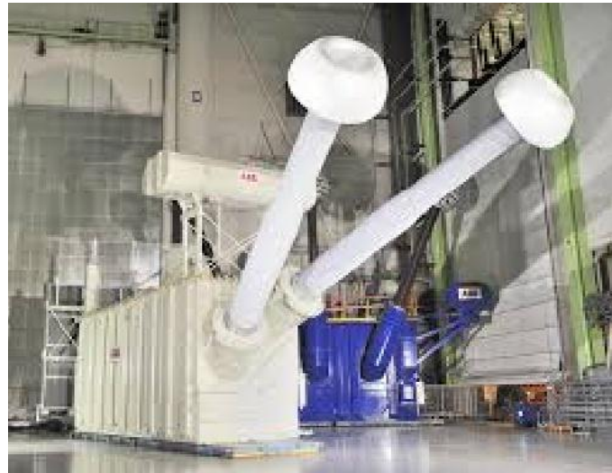
شکل (۳-۴) ترانسفورماتور HTS ساخت Fuji – SEC و دانشگاه Kyushu
